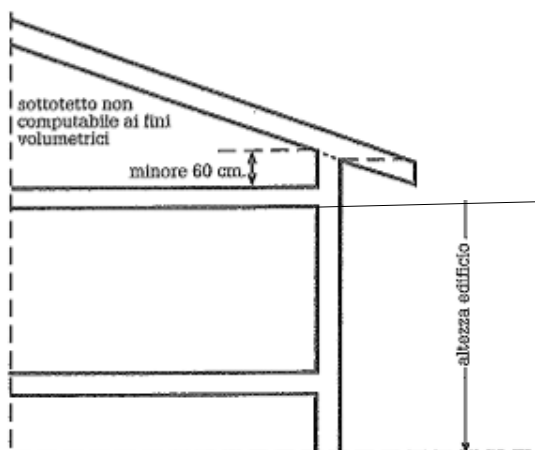
SOTTOTETTO NON PRATICABILE Fig. 1 - Edificio con dislivello inferiore a 60 cm e gronda inclinata
